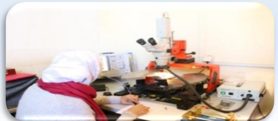
جهاز لقياس معامل العزل للمواد
