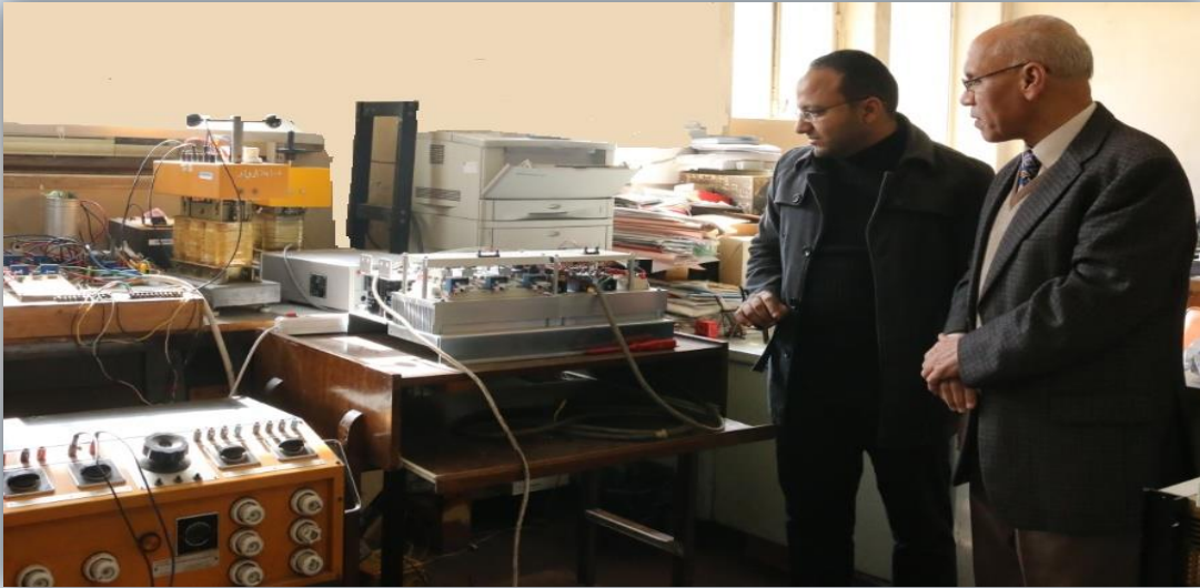
جهاز تحويل التيار المتردد الي تيار مستمر (Converter used to convert AC to DC)
